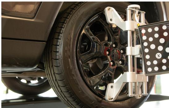
Con un design autocentrante, le unghie bilaterali garantiscono una presa solida e rapida, anche sui coprimozzo.
